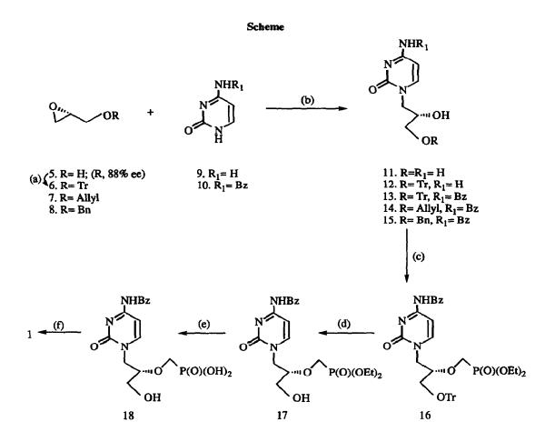
**Reaction Conditions:** (a) TrCl, TEA,  $CH_2Cl_2$ , rt, 3 h; (b)  $K_2CO_3$ , DMF,  $72^{O}C$ , 5 h or NaH (0.22 eq), DMF,  $105^{O}C$ , 5 h; (c) TsOCH<sub>2</sub>P(O)(OEt)<sub>2</sub>, NaH (3 eq), DMF,  $0^{O}C$ , 6 h; (d)  $HCl_g$ ,  $CH_2Cl_2$ ,  $0-5^{O}C$ , 10 min.; (e) TMSBr,  $CH_2Cl_2$ , rt, 18 h; (f) Conc. NH<sub>4</sub>OH, rt, 4 h.
